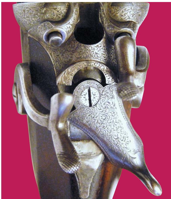
Илл. 18. Принципиальная схема запирающего механизма В. М. Скотта (British Patent № 2752 от 1865 года), объединившего верхний рычаг с нижней планкой Пёрде посредством вертикальной оси
