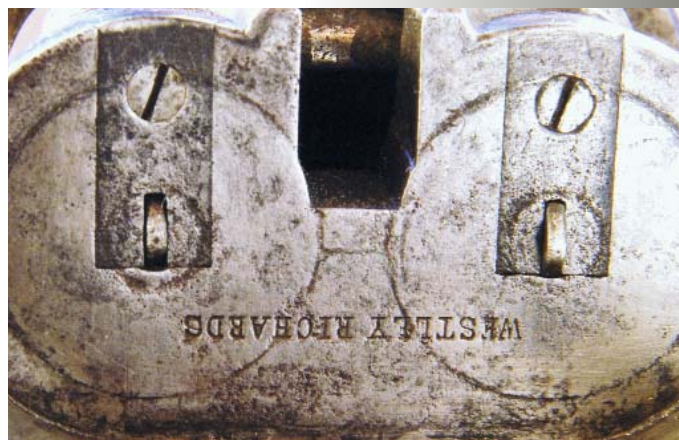
Илл. 12. Щиток коробки с перевёрнутым торговым логотипом и двусоставными бойками, имеющими плоскую ударную часть
