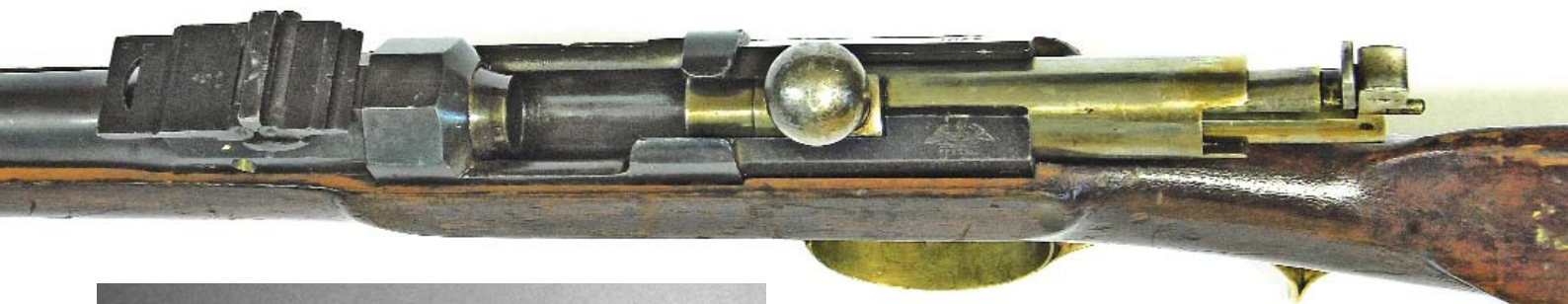
Затвор с иголь- ударником винтовки Дрейзе М/41. Фото: Тони Виртманн
